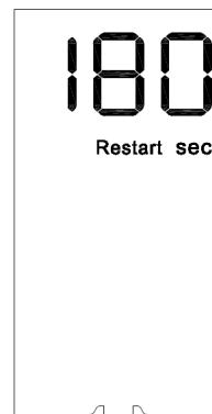
Stav ochrany kompresora
