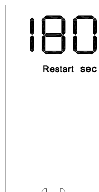
Režim zaštite kompresora
