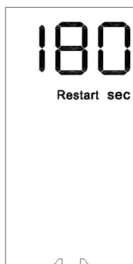
Stav ochrany kompresoru
