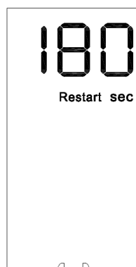
Estado de protección del compresor
