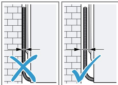
Cevi in električnega kabla ne priprite med steno in aparat.
