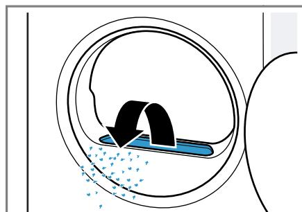
Pazite, da vlakna ne padejo v zračni kanal.
