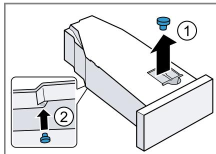
2. Očistite filter v posodi za kondenzat.
