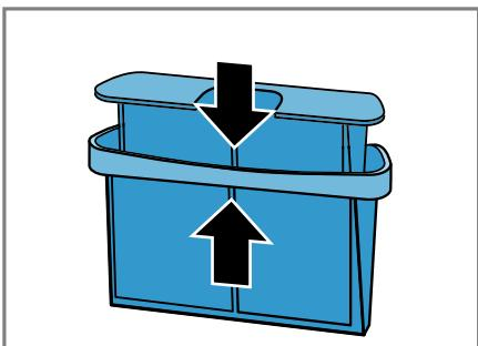
8. Vstavite dvodelni filter za vlakna.
