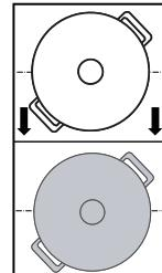
Aparat zazna posodo in v prikazu novega kuhalisča izmenično utripata predhodno izbrana stopnja kuhanja in  $\text{L} \text{S}$ .
