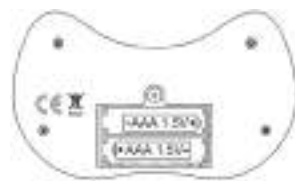
Insérer deux piles AAA (1,5V)
